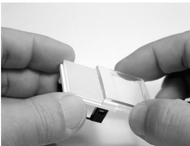
照光部のカバーを横にスライドさせることにより、取り付け、取り外しできます。
