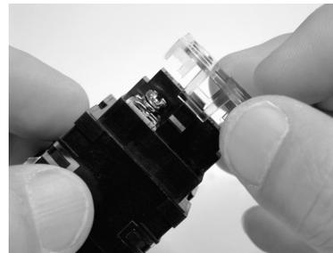
ねじ締め端子ベースと端子カバーのフック部を合わせて取り付けてください。
