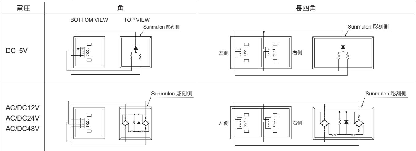
※全面単色照光 (輝度低減) をご使用の場合は、別回路へ電流の回り込み防止のため、切り換え回路等下図のような回路を入れてください。
