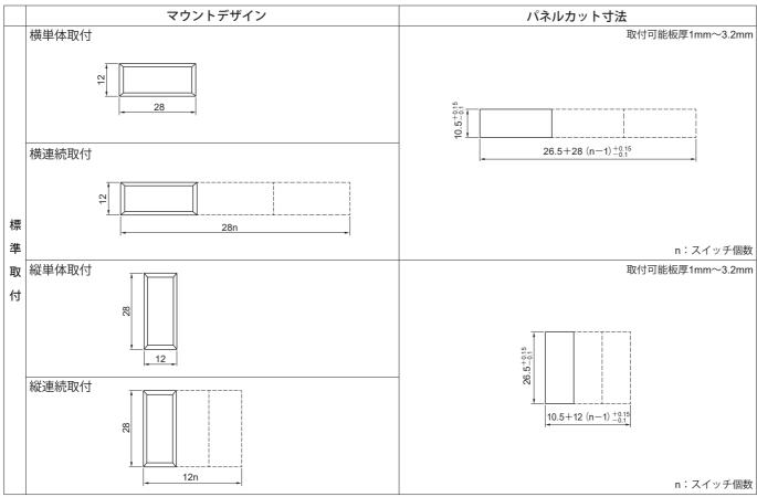
※パネルに塗装処理等の外装処理をする場合、外装処理後の寸法がパネルカット寸法になるようにお願いします。 パネルカット寸法が小さくなりますと動作不良の原因となります。
