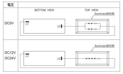
※抵抗内蔵タイプの内部接続を表しています。※抵抗なしタイプは図中の抵抗部分をショートした形になります。
