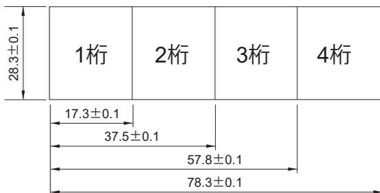
※防水タイプで2桁以上を同一取付穴でご使用する場合は上記のように必ずセットでご指定ください。
