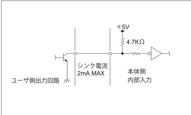
※内部は+DC5V電源で動作していますので、ユーザ側はオープンコレクタ出力回路にするか、+5V以上印加しない出力回路にしてください。
