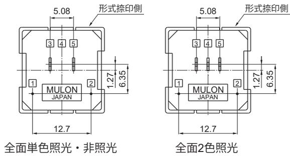
●プリント基板穴あけ寸法 (TOP VIEW)
