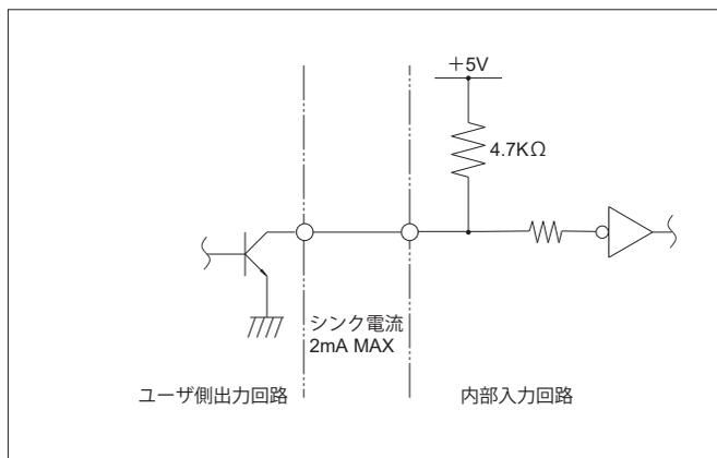
※内部は+DC5V電源で動作していますので、ユーザー側はオープンコレクタ出力回路にするか、+DC5V以上印加しない出力回路にしてください。
